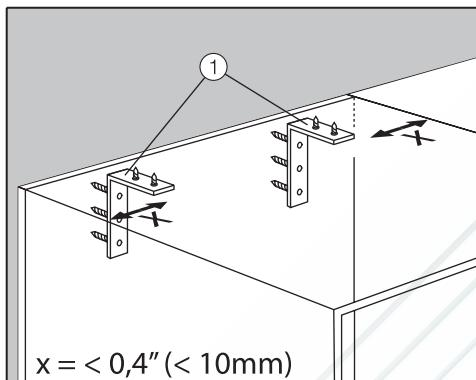
Используйте для каждого отдельного прибора два крепления от опрокидывания или для каждой комбинации приборов (Side-by-side) - четыре крепления.
